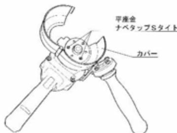
2) カバーを開いた状態で、アクセルランダムユニットをスピンドルにねじ込み、2本のスパナ(17mm)で締めつけます。
